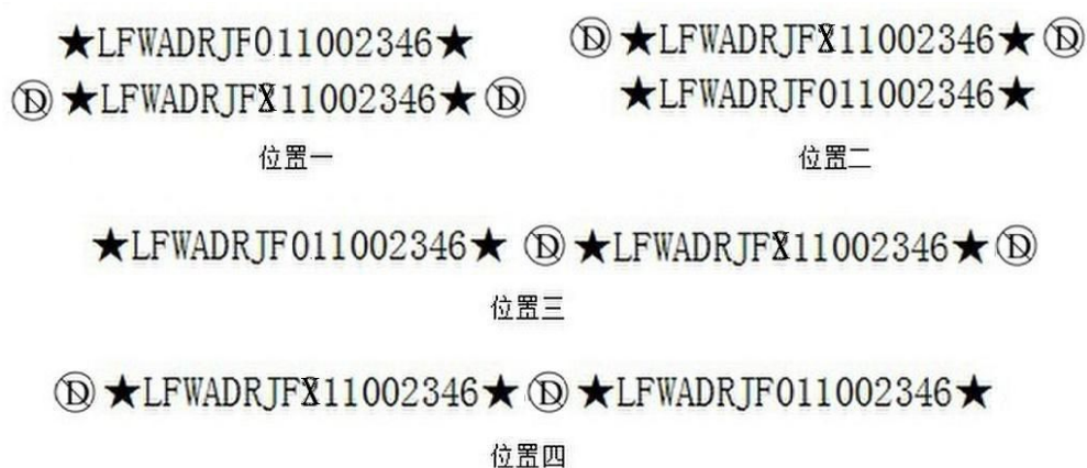
图5 除 M_1 、 N_1 、 L_1 、 L_3 类车辆之外的车辆 的车辆识别代号变更示意图
