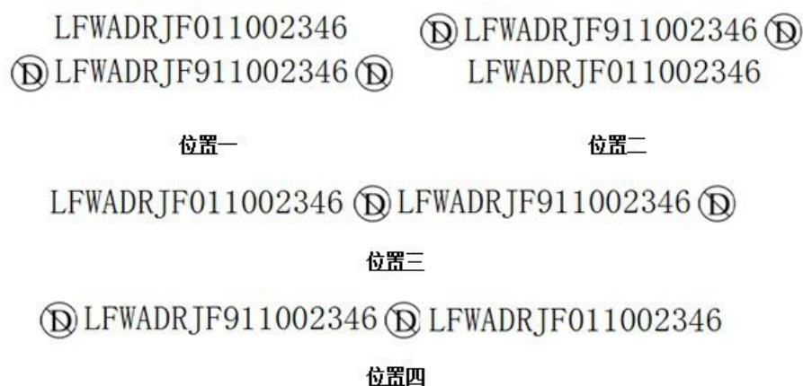
图 6 M_1 、 N_1 、 L_1 、 L_3 类车辆的车辆识别代号变更示意图
