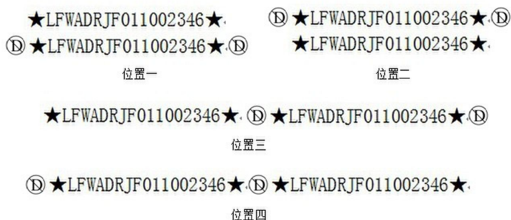
图4 重新标示的车辆识别代号位置示意图
